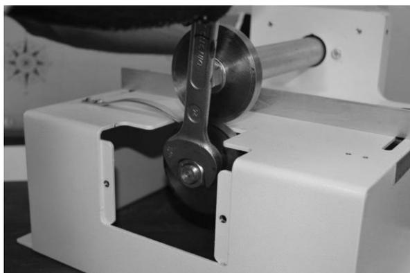
6. Inverta a face dos discos ou os substitua. Após isso feito, reaperte os parafusos e recoloca todas as proteções.
