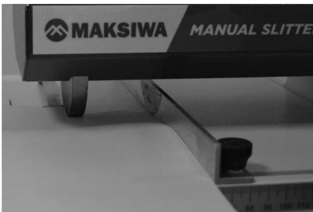
3. Com o material encostado na guia e encostado nos discos de corte, gire a alavanca realizando o corte:
