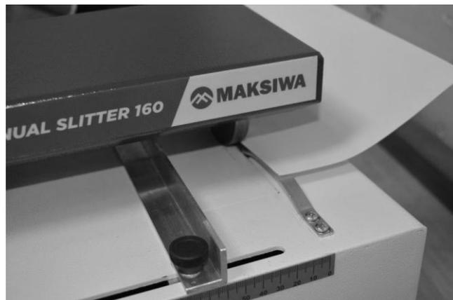
4. Continue apoiando o material contra a guia e girando a alavanca até completar o corte de toda a peça.
