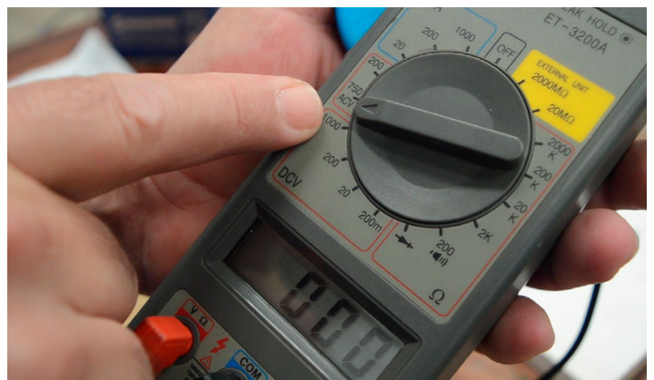
Fig.101 - Multímetro na escala ACV 750V
