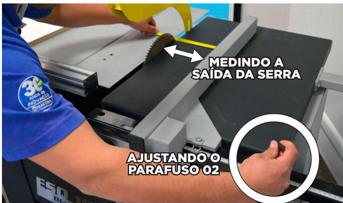
Fig.179 - Ajustando a saída da serra
