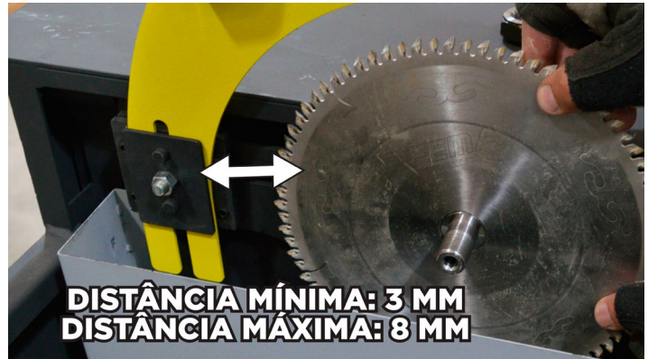
Fig.129 - Colocando a serra no sistema de corte com o espaçamento mínimo de 3 mm e máximo de 8 mm
