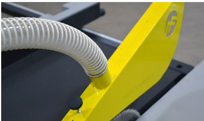
Fig.148 - Mangueira instalada no protetor de serra
