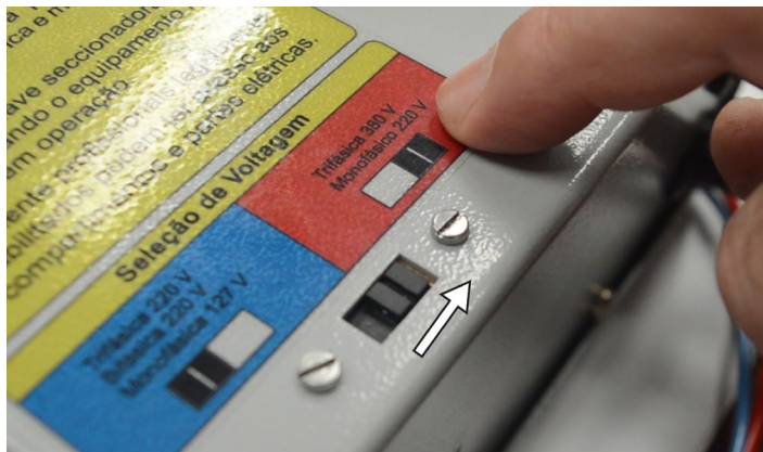
Fig.98 - Chave seletora na posição Monofásica 220V
