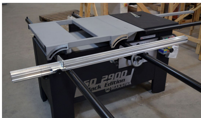
Fig.39 - Guia em alumínio sobre os varões
