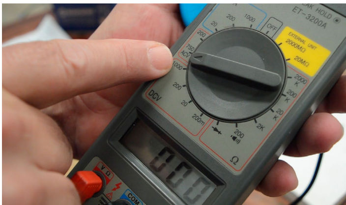
Fig.61 - Multímetro na escala ACV 750V
