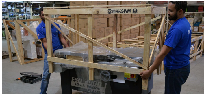
Fig.02 - Retirando a máquina do pallet
