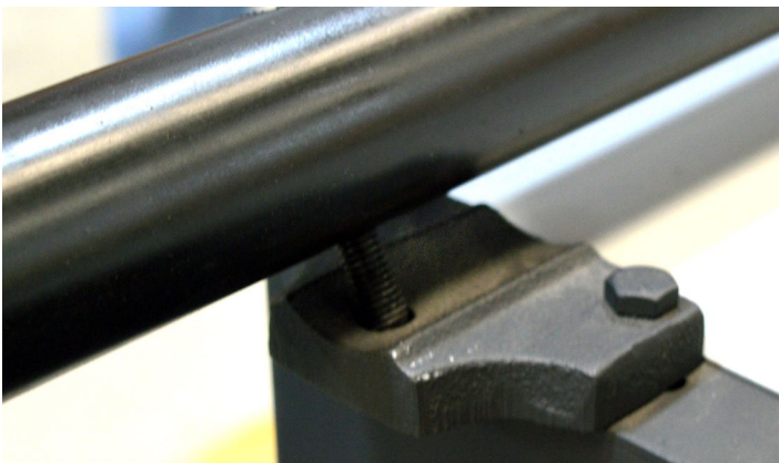
Fig.17 - Encaixando os varões na base (detalhe)
