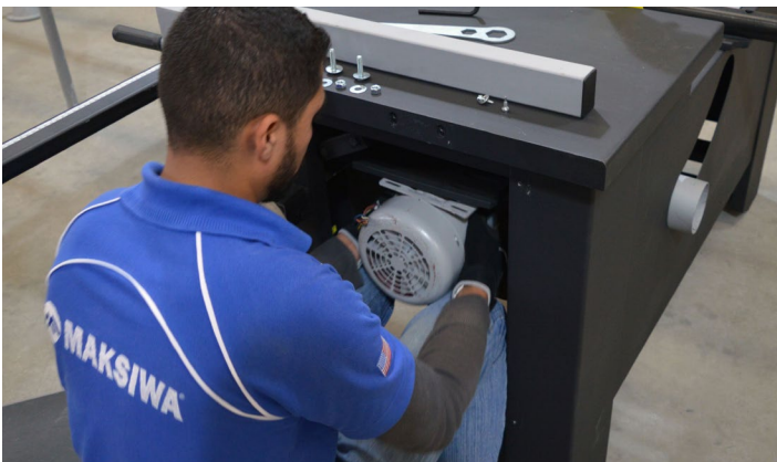
Fig.118 - Fixando o motor na base
