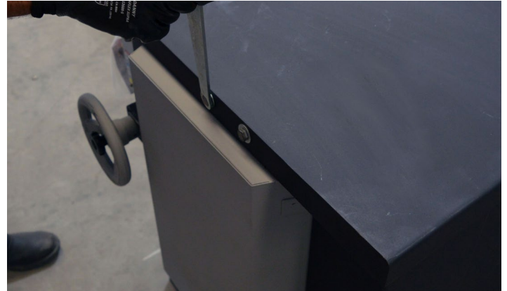
Fig.34 - Soltando os parafusos do prolongador
