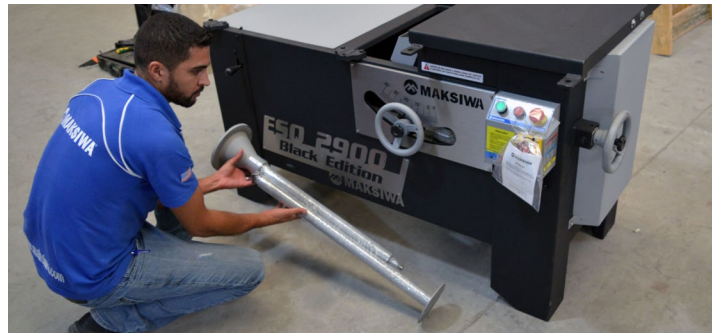
Fig.07 - Retirando os pés e apoios embaixo da máquina
