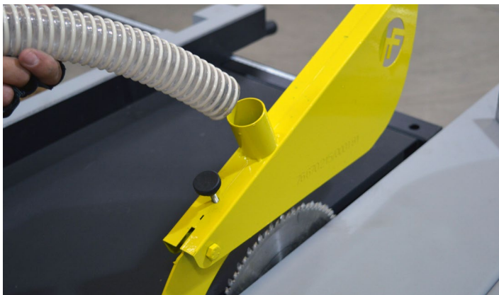
Fig.147 - Instalando a mangueira no protetor de serra
