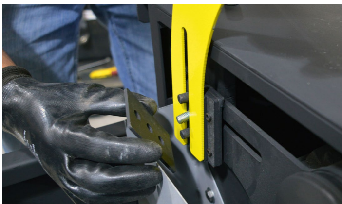
Fig.47 - Encaixando o protetor entre o parafuso e os pinos
