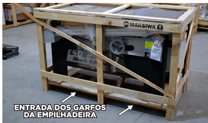
Fig.01 - Máquina no pallet com os locais indicados para a empilhadeira
