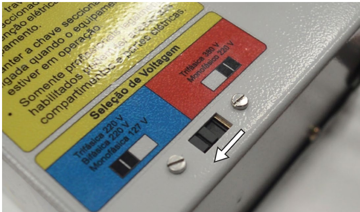
Fig.68 - Chave seletora na posição Monofásica 127V
