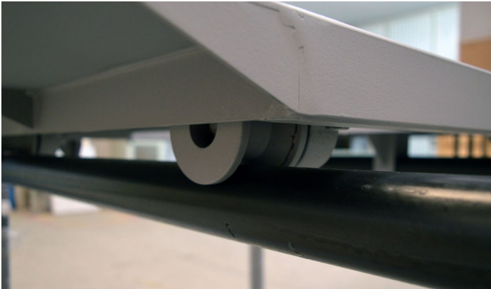
Fig.23 - Mesa móvel encaixada no varão
