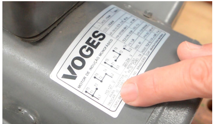
Fig.62 - Plaqueta de identificação do motor
