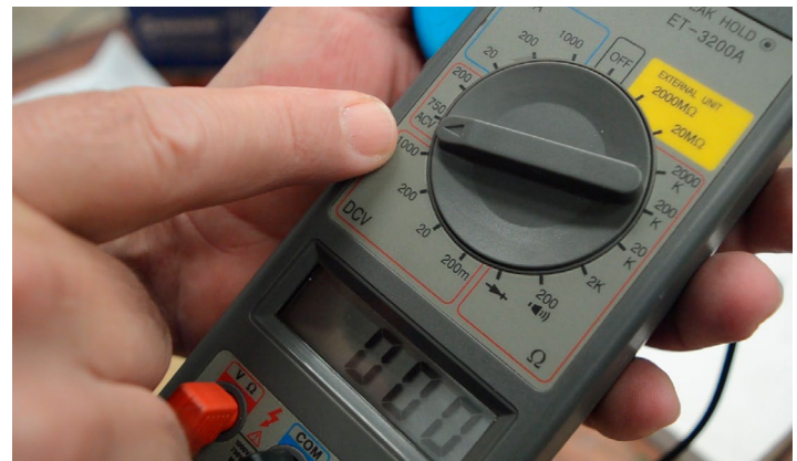
Fig.71 - Multímetro na escala ACV 750V
