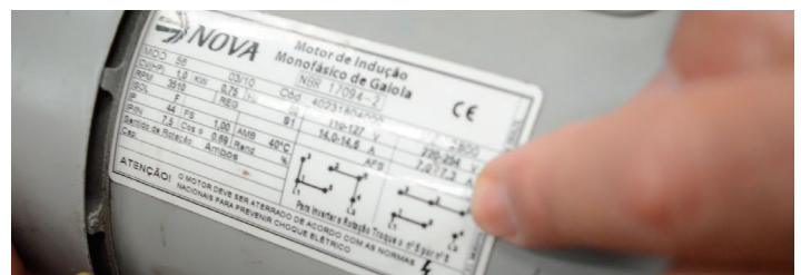
Fig.72 - Plaqueta de identificação do motor
