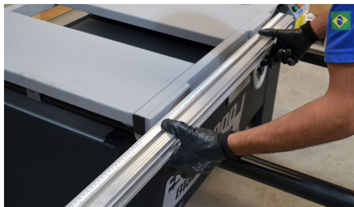
Fig.41 - Encaixando a guia em alumínio
