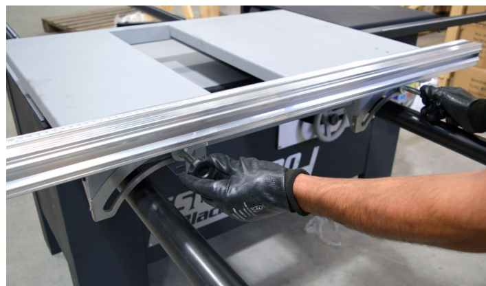
Fig.43 - Guia em alumínio instalada
