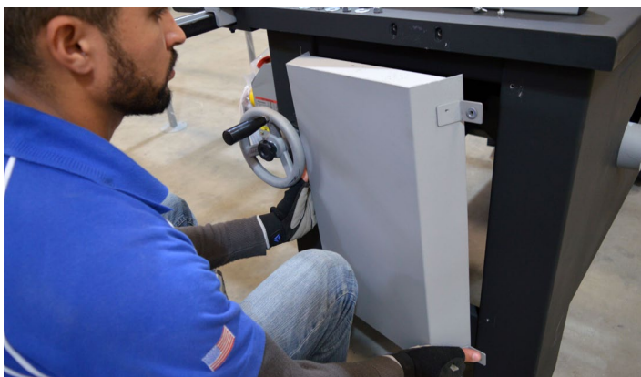
Fig.113 - Retirando a tampa protetora do motor
