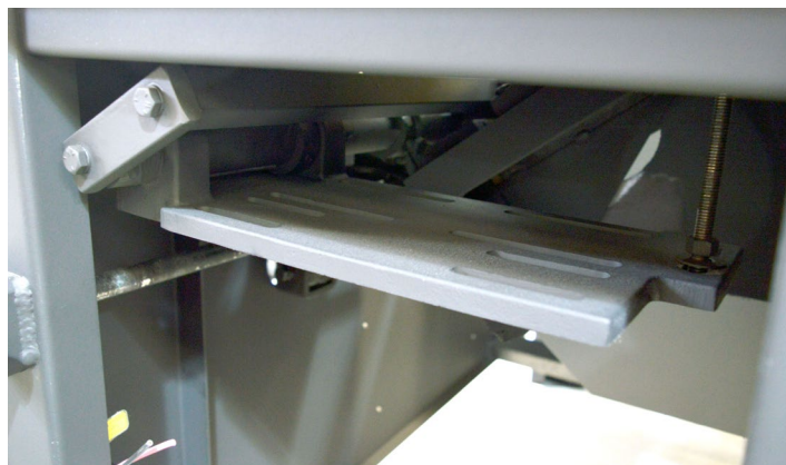
Fig.116 - Base do motor instalada
