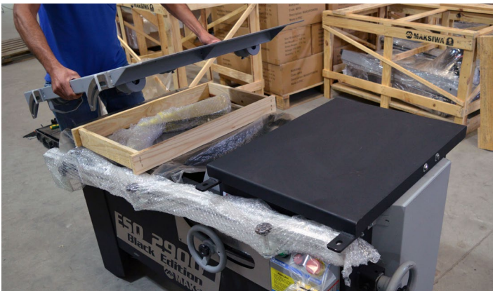
Fig.04 - Retirando a mesa móvel
