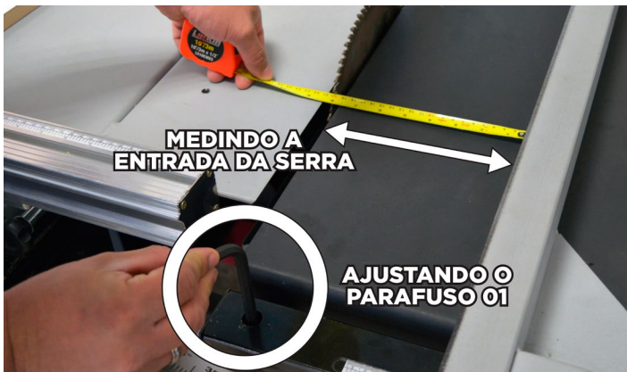
Fig.179 - Ajustando a entrada da serra
