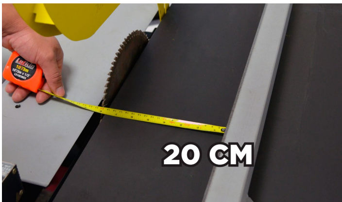
Fig.174 - Medindo a entrada da serra
