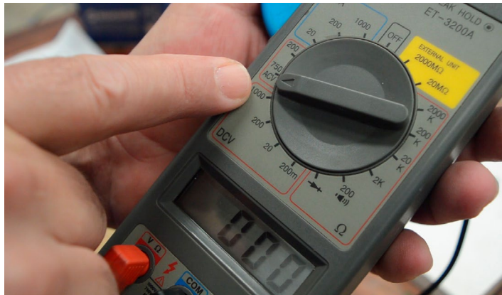
Fig.81 - Multímetro na escala ACV 750V
