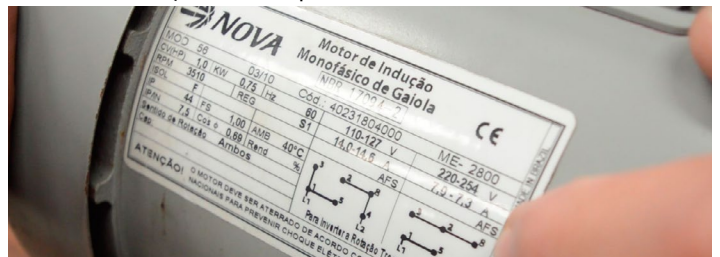
Fig.92 - Plaqueta de identificação do motor
