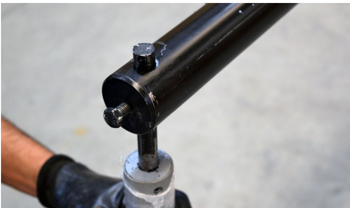
Fig.24 - Pinos levantados para travar a mesa móvel
