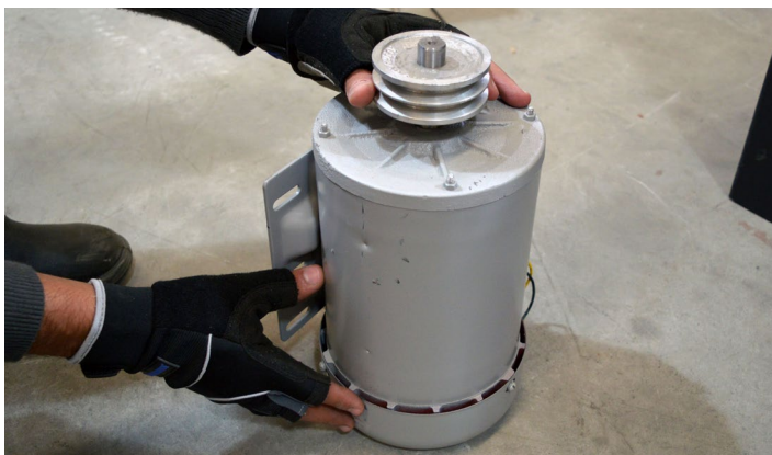
Fig.112 - Polia instalada no motor
