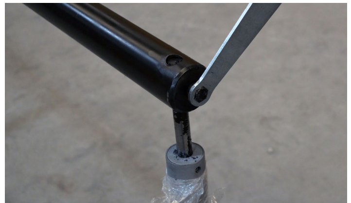
Fig.21 - Encaixando os pés e apertando o parafuso
