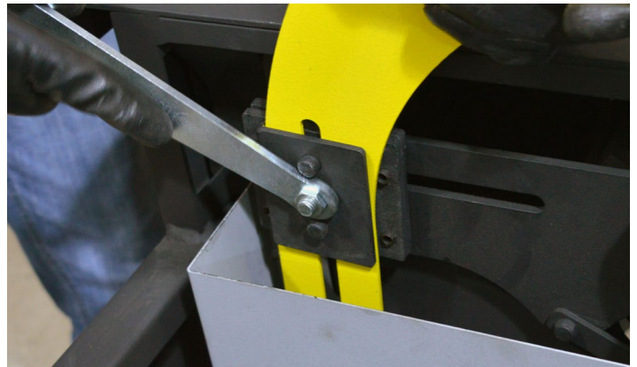
Fig.49 - Apertando o parafuso do protetor
