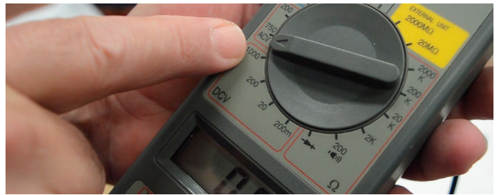
Fig.91 - Multímetro na escala ACV 750V
