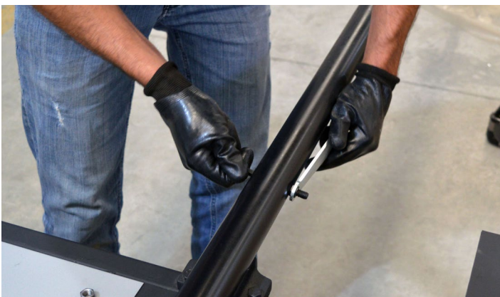
Fig.18 - Apertando os parafusos com os varões encaixados
