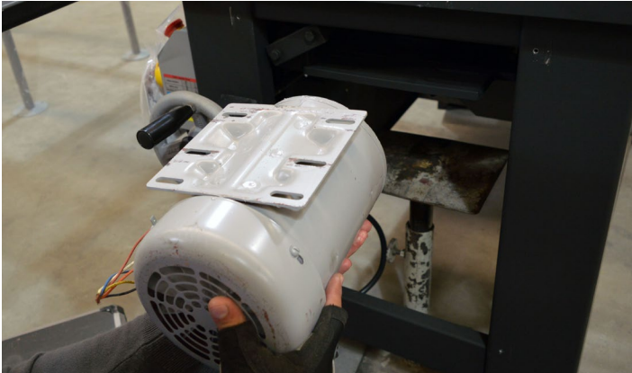
Fig.117 - Instalando o motor na base com ajuda de um suporte
