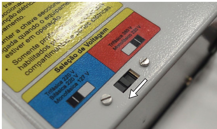
Fig.88 - Chave seletora na posição Trifásica 220V
