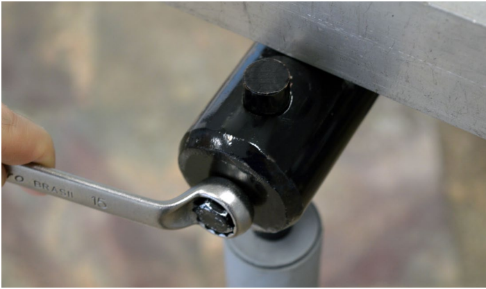
Fig.29 - Apertando os parafusos para travar o varão
