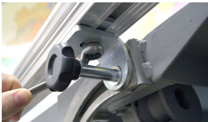
Fig.186 - Ajustando a guia em alumínio para alinhar o esquadro
