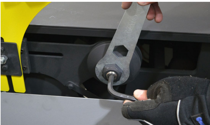
Fig.126 - Retirando a porca do sistema de corte
