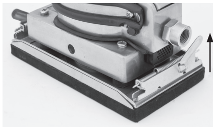
Fig. 3 – Instalação da lixa
