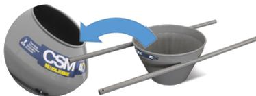
**01 - Com a máquina desligada, inclinar o tambor conforme posição ideal para carga. Com a máquina ligada, acionar a caçamba para carregar o tambor.**
