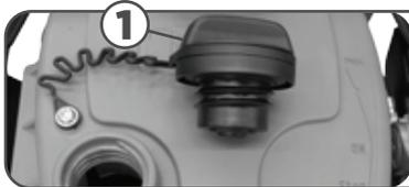
Abrir a tampa ① do depósito, controlar o nível. Se necessário, atestar com combustível limpo, conforme especificação, até ao bordo inferior do tubo de abastecimento.
