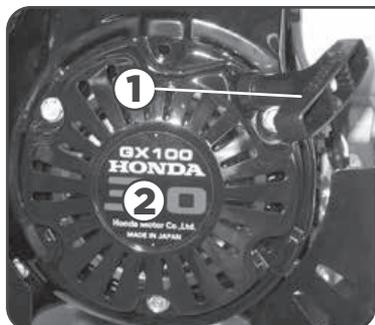
Puxar devagar o punho ① do mecanismo de arranque por cabo ②, até sentir resistência.
