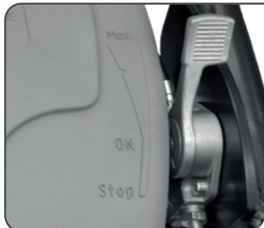
Levar o acelerador à posição de engate da velocidade máxima (Max.).
