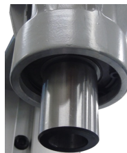
Fig. 2 – Encaixe para broca cônica sem o uso de adaptador
