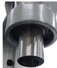
Fig. 2 – Encaje para broca cónica sin el uso de un adaptador
