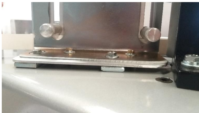
Figura 9 - Regulagem da fita de borda
