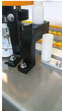
Figura 3 - Instalação do destopador
