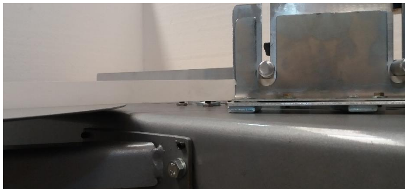
Figura 6 – Altura do prato da fita de borda
