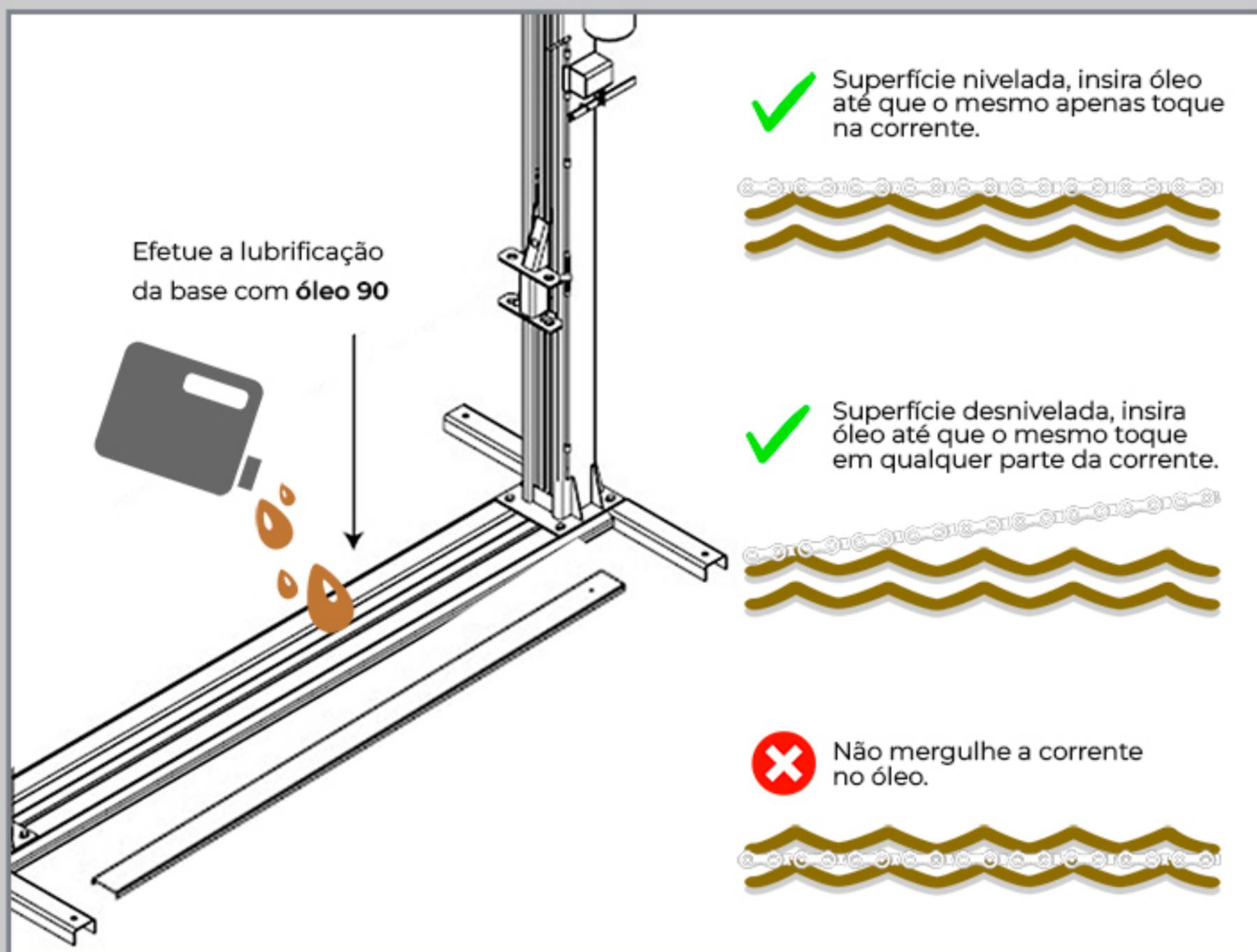
A lubrificação deste elevador é especialmente a óleo conforme a imagem abaixo, mas recomendamos a lubrificação com **graxa** nas **laterais da coluna** onde correm as **roldanas**. Outro ponto que deve ser inserido **graxa** são os **rolamentos superiores**. Não lubrifique os fusos com graxa, isso irá entupir o canal de acesso ao óleo.
