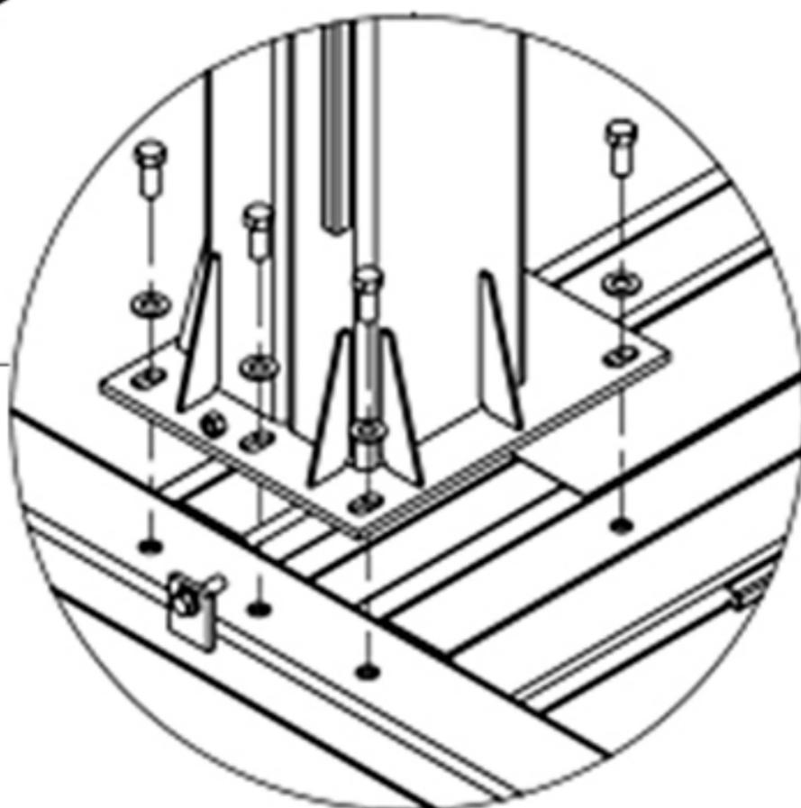
**5)** Execute o mesmo procedimento com a outra coluna. Coloque os parafusos da base da coluna sem apertá-los, permitindo o esticamento da corrente. Aperte o esticador, certificando-se de que a corrente esteja apertada. Após esta operação, aperte os parafusos da base. A tensão ideal da corrente esticada deverá permitir que você consiga apenas com o polegar e o indicador de uma das mãos aproximar os dois lados da corrente sem muito esforço.
