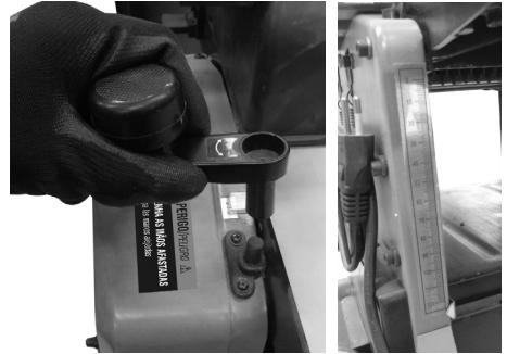
Fig. 13 – Ajuste de la mesa en el modo afinado
