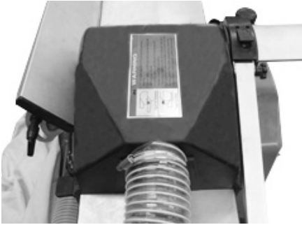
Fig. 12 – Instalación de la caja colectora de polvo sobre las cuchillas
