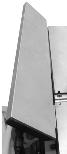
Fig. 10 – Ajuste da guia lateral em 45°
