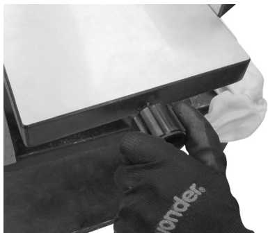
Fig. 8 – Ajuste de la mesa
