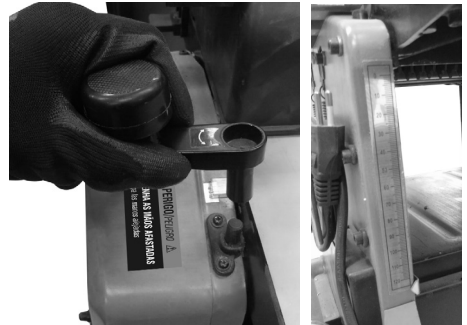
Fig. 13 – Ajuste da mesa no modo desengrossadeira
