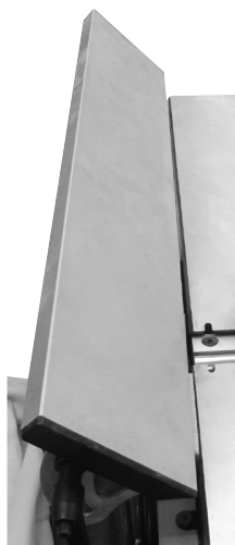
Fig. 10 – Ajuste la guía lateral a 45°
