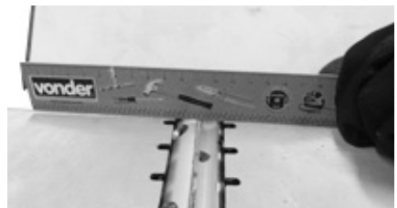
Fig. 14 – Reglaje de las cuchillas
