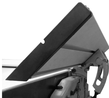
Fig. 9 – Ajuste da guia lateral de acordo com o ângulo
