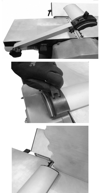
Fig. 7 – Ajuste la guarda de protección
