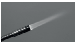
Figura 6 – Ajuste correto da chama com pouco gás
