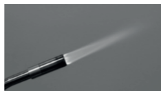
Figura 6 – Ajuste correcto de la llama con poco gas
