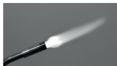
Figura 7 – Ajuste correcto de la llama con mucho gas
