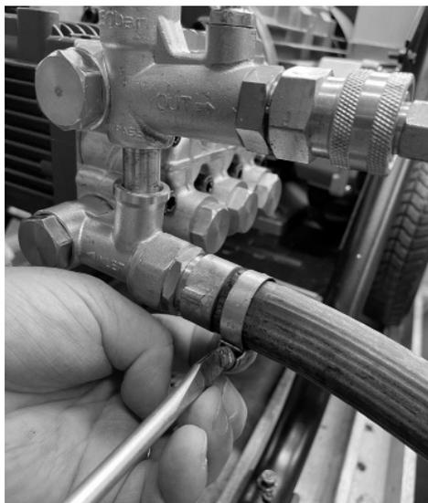
1. Remova a mangueira de alimentação da conexão de entrada de água.
