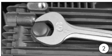
2. Com o auxílio de uma chave de boca, remova o tampão vermelho que está instalado na bomba.
