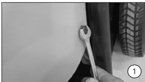
1. Remova os parafusos laterais do capô com o auxílio de uma chave de boca.
