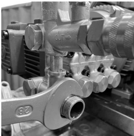
3. Retire a conexão união utilizando uma chave de boca
