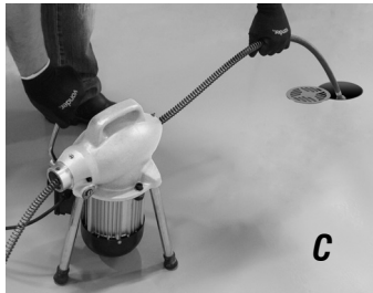
Figura 3 – Operação com o cabo de 16 mm (5/8")
