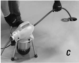
Figura 3 – Operación con cable espiral de 16 mm (5/8")
