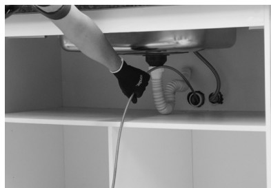
Figura 5 – Operação com cabo espiral de 8,0 mm (5/16”)
