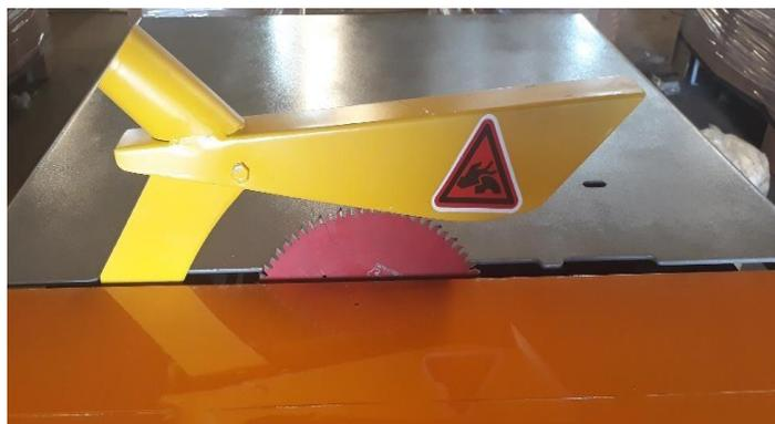
*Figura 39 – Altura máxima em 90° - 6mm*
