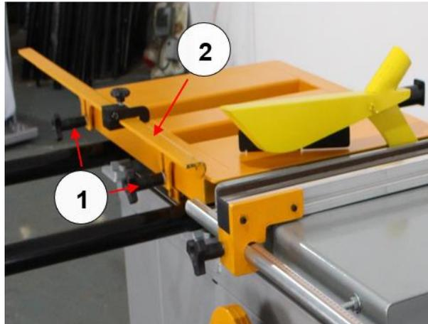
*Figura 22 - Itens para instalação do paralelo móvel*
