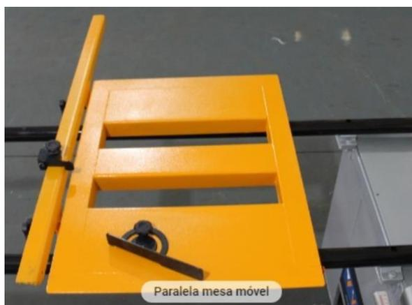
*Figura 14 - Acoplamento da mesa móvel*
