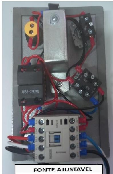
Figura 4 - Painel c/ fonte ajustável
