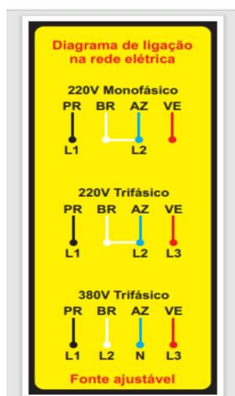
Figura 5 - Legenda para instalação painel 2
