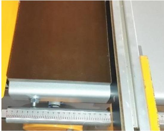
*Figura 35 - Fixação da fita métrica no paralelo da mesa fixa*
