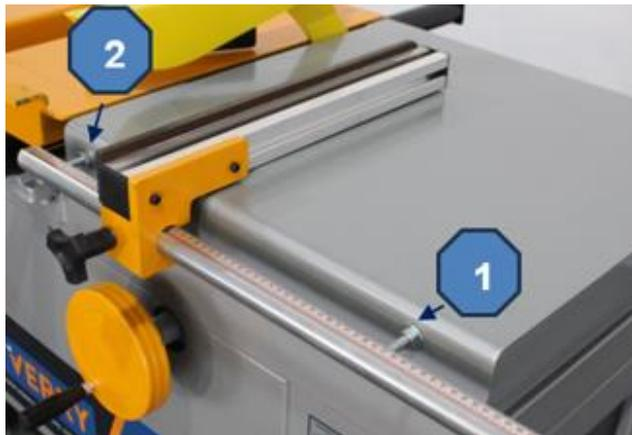
*Figura 32 - Instalação do varão de apoio*
