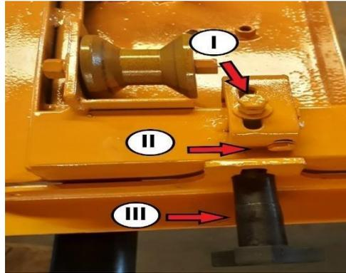
Figura 30 - Sistema regulador do paralelo móvel
