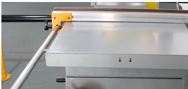
*Figura 33 - Nivelamento do paralelo fixo*
