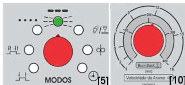
Ligando a Fonte de soldagem com a tecla “SET” (CH2 – face traseira da placa) pressionada e o Potenciômetro de Modos [5] apontado para a função **Intermitente**, o LED associado irá piscar. Através do Potenciômetro velocidade do arame e Burn Back [10], o operador definirá o modelo da máquina:
