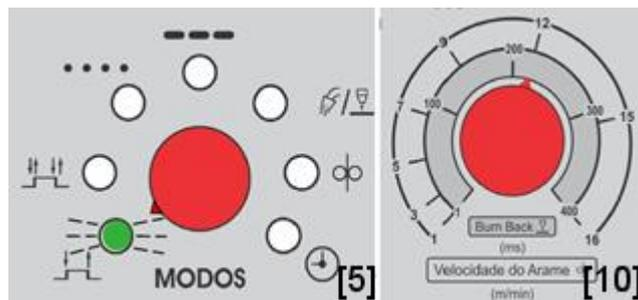
Ligando a fonte de soldagem com a tecla “SET” (CH2 – face traseira da placa) pressionada e o Potenciômetro de Modos [5] apontado para a função **2 Passos**, o LED associado irá piscar. Pressionando o gatilho e mantendo pressionado o ajuste de velocidade mínima poderá ser feito através do Potenciômetro velocidade do arame e Burn Back [10], quando chegar à velocidade desejada soltar o gatilho e pressionar novamente. Todos os LED’s irão acender por um segundo indicando a gravação.
