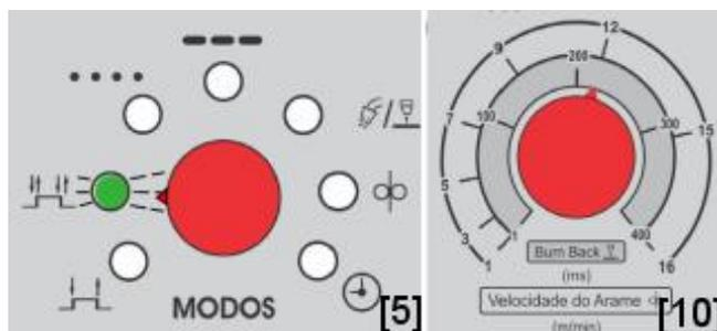
Ligando a Fonte de soldagem com a tecla “SET” (CH2 – face traseira da placa) pressionada e o Potenciômetro de Modos [5] apontado para a função **4 Passos**, o LED associado irá piscar. Pressionando o gatilho e mantendo pressionado o ajuste de velocidade máxima poderá ser feito através do Potenciômetro velocidade do arame e Burn Back [10], quando chegar à velocidade desejada soltar o gatilho e pressionar novamente. Todos os LED’s irão acender por um segundo indicando a gravação.
