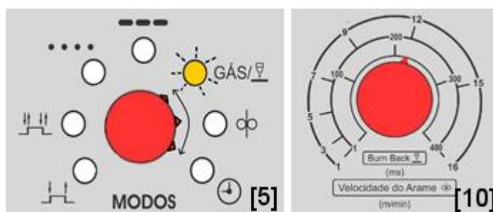
Ligando a Fonte de soldagem com o gatilho pressionado e o Potenciômetro de Modos [5] apontado para o lado direito da escala (função: Teste gás, Inserção de arame ou Ajuste tempos), o LED de indicação de *Burn Back* começará a piscar. Através do Potenciômetro velocidade do arame e *Burn Back* [10], o operador definirá o tempo de *Burn Back*. Para finalizar, deve-se pressionar o gatilho da tocha novamente.
