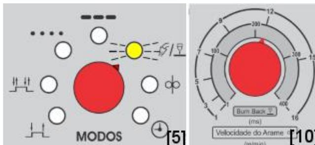
Ligando a Fonte de soldagem com a tecla “SET” (CH2 – face traseira da placa) pressionada e o Potenciômetro de Modos [5] apontado para a função **Teste de gás**, o LED associado irá piscar. Através do *Potenciômetro velocidade do arame e Burn Back [10]*, o operador definirá se a placa será controlada por tecla ou por potenciômetro:
