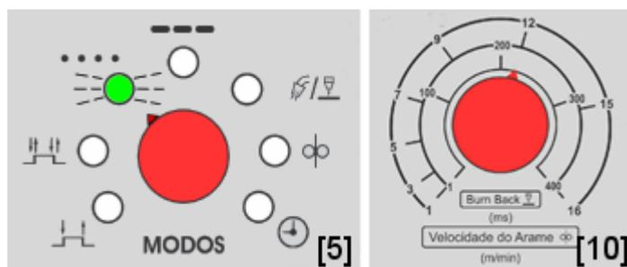
Ligando a fonte de soldagem com a tecla “SET” (CH2 – face traseira da placa) pressionada e o Potenciômetro de Modos [5] apontado para a função **Ponteamento**, o LED associado irá piscar. Através do *Potenciômetro velocidade do arame e Burn Back* [10], o operador definirá o tipo de alimentador:
