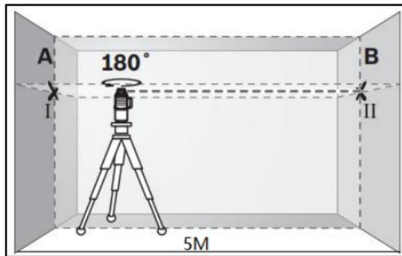
4. Sem girar a ferramenta, posicione-a perto da parede B. Ligue a ferramenta e deixe-a nivelar.
