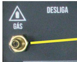
Entrada do gás na máquina: recomenda-se o uso de abraçadeiras metálicas para fixar e evitar vazamentos
