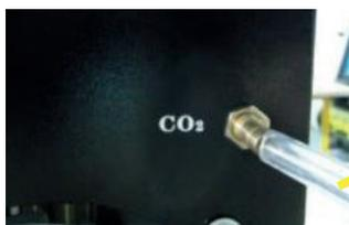
Entrada do gás na máquina: recomenda-se o uso de abraçadeiras metálicas para fixar e evitar vazamentos
