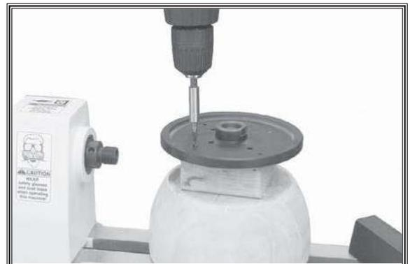
**Figura 35.** Exemplo de montagem da peça na placa lisa usando um bloco de apoio.
