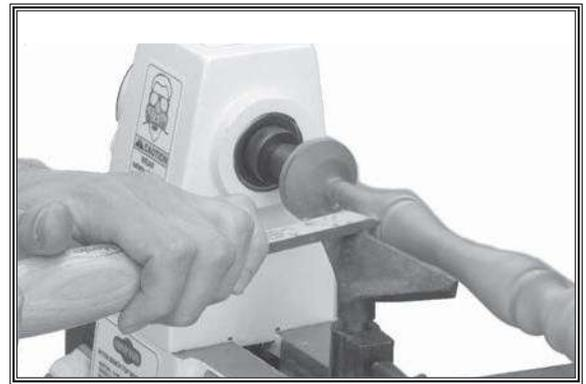
**Figura 30.** Exemplo de operação típica de torneamento no eixo-árvore (cabeçote móvel não mostrado)
