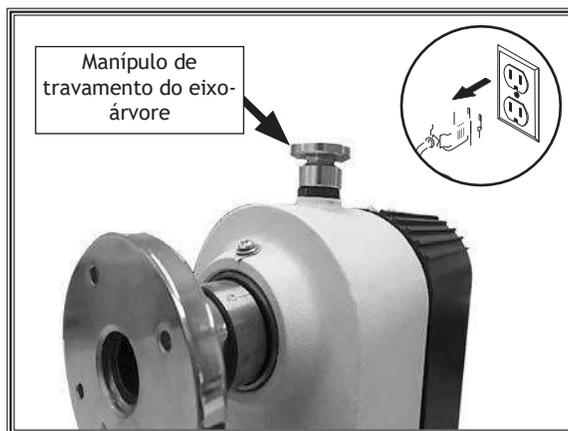
**Figura 25.** Manípulo de travamento do eixo-árvore na posição *Locked* (Travado).
