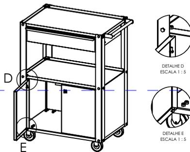
6 - Fixe as duas Portas, observando os detalhes "D" e "E" da figura. Desta forma o Carrinho estará completamente montado.
