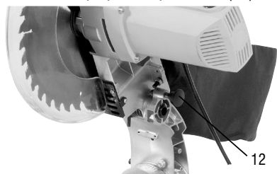
Fig. 6 – Procedimento para levantar o cabeçote
