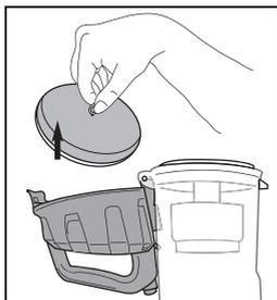
Retire o filtro de espuma e agite até retirar toda a poeira. Enxague o filtro espuma e seque completamente.
