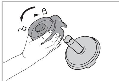
Aperte as abas e levante o filtro. Gire no sentido anti-horário para desbloquear, agite o pó e enxague. Depois, seque completamente. Gire no sentido horário para bloquear.
