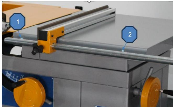
*Figura 32 - Instalação do varão de apoio*
