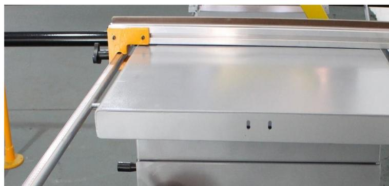
*Figura 33 - Nivelamento do paralelo fixo*
