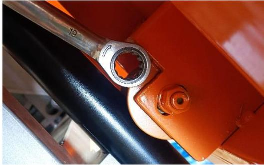
*Figura 25 - Regulagem de altura da mesa móvel*
