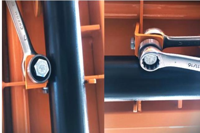
*Figura 20 - Posicionamento do rolamento*
