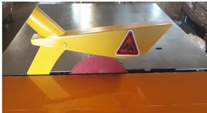
Figura 41 – Altura máxima em 90° - 6mm
