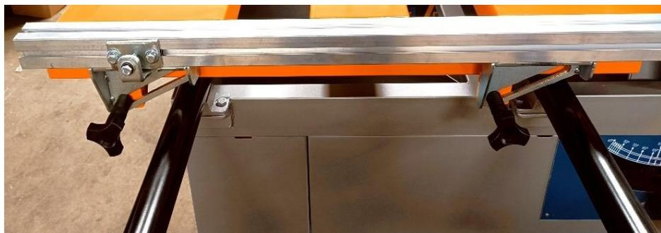
*Figura 26 - Instalação do paralelo móvel*
