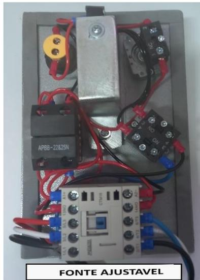
Figura 4 - Painel c/ fonte ajustável
