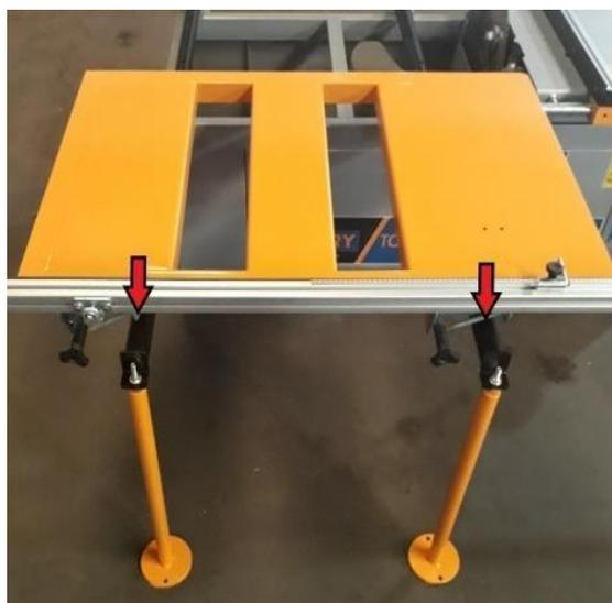
*Figura 14 - Acoplamento da mesa móvel*
